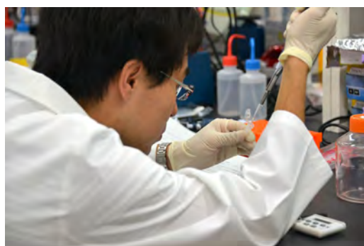
反応産物をゲル濾過カラムに滴下して精製
