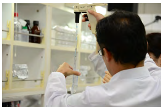
電動ピペッターで 4.0 mL ずつ試薬を分取
