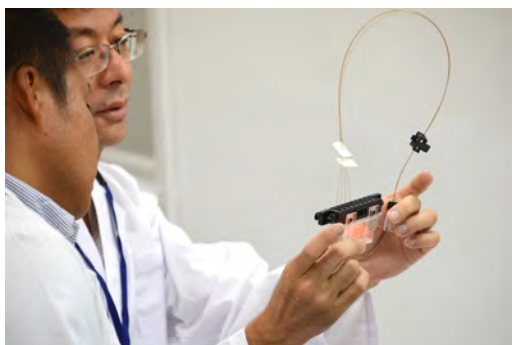
キャピラリーと電極・検出部を確認
