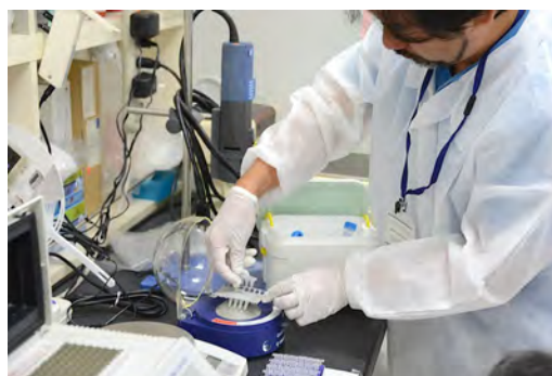
卓上遠心機で軽く落としてから装置にセット
