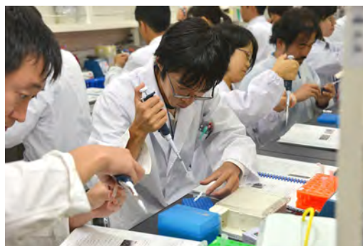
ゲル電気泳動用に PCR 産物と色素を混合
