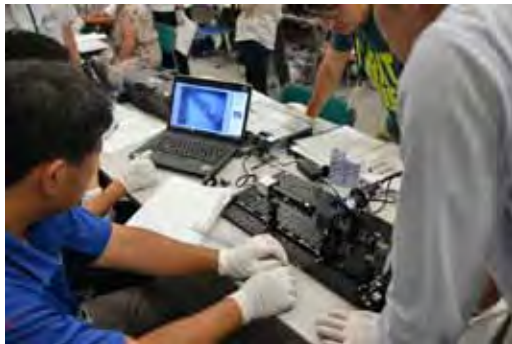
ステージを動かしてピントを調整
