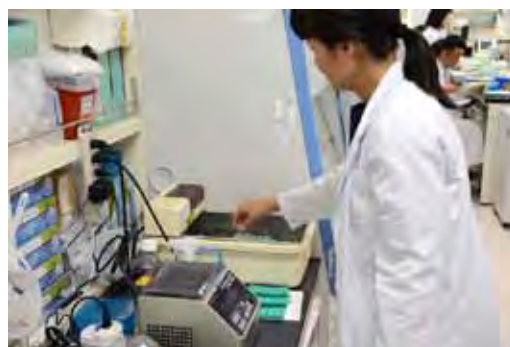
50°Cの恒温水槽でタンパク質分解反応
