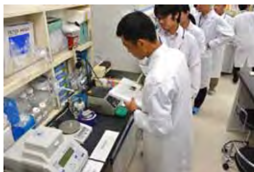
電子天秤で空のチューブの重さを量る
