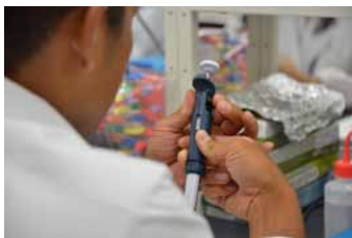
マイクロピペッターのダイヤルを合わせる
