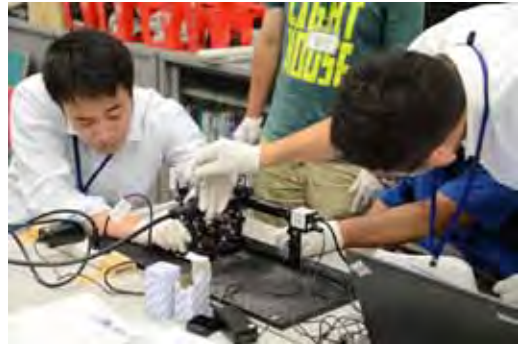
高さを揃えて光軸を直線上に
