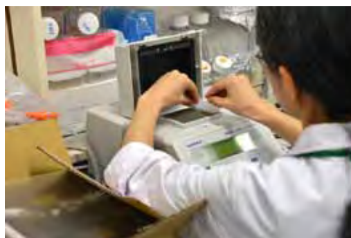
サーマルサイクラーにセットして反応開始
